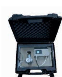
Misura della qualità dell'aria compressa
