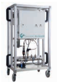
Misura della qualità dell'aria compressa
