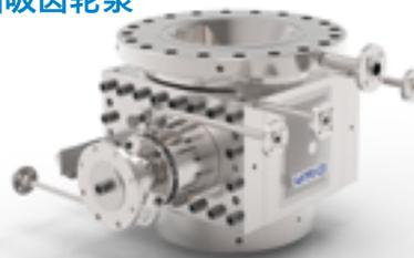
POLY齿轮泵用于输送真空反应器中的中高粘度介质。超大的吸入口, 在真空或较低的NPSH的条件下, 使高粘介质能够很好的吸入齿轮泵。
