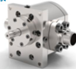
中低粘度齿轮泵，主要应用中低粘度产品的输送和计量，如预聚物、单体和其它化工流体。数十年的结构设计及选材经验使得CHEM泵几乎能够满足各种要求，可在真空和高压条件下应用。如可输送有毒、易燃以及在大气中易结晶的介质。威特也可以提供磁耦合驱动的CHEM泵，将输送介质与外界完全隔离。无泄露磁耦合驱动齿轮泵的系统压力可达到500bar。CHEM泵同样适用于食品工业，如传送黄油、人造奶油、植物油和乳酸等。
